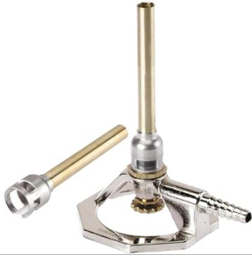
ULバーナーH-5025は、UL94およびASTM規格D5025に準拠したプラスチック材料小規模燃焼試験用のバーナーです。バーナーはメタンガスを供給して使用することで、炎の高さが20~125mmに調整することができます。
