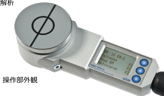
スパーサーゲージを使用しての測定
