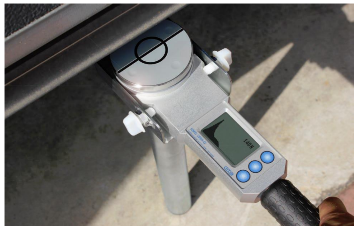
スパーサーゲージを使用しての測定
