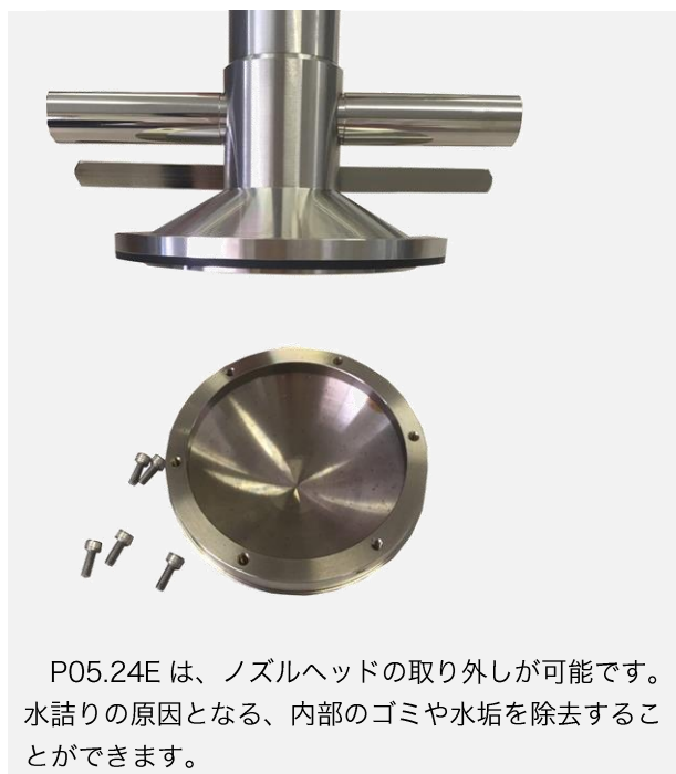
付図 5 散水及び飛まつに対する手持試験装置：第二特性数字 3 及び 4 (散水ノズル)
